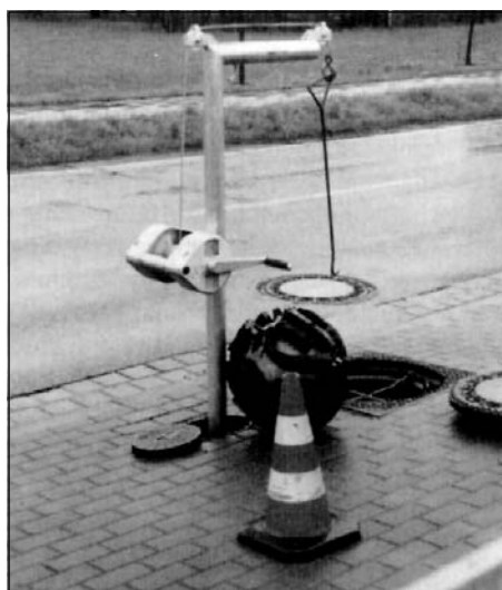
7. kép. A csatornagolyók kiemelésére szolgáló csörlő
