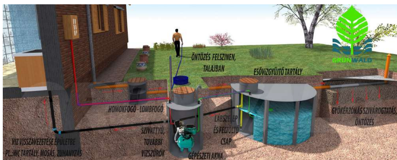
3. ábra: Esővízgyűjtő rendszer lehetséges kialakítása (forrás: tartalyhaz.hu)
