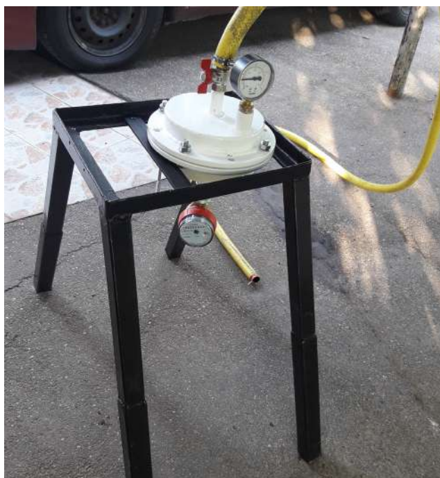
2. ábra: A mintavevő rendszer elemei: A fehér szűrőház állványon, a kifolyó vízmennyiséget 1/2 collos vízórával mértük.
