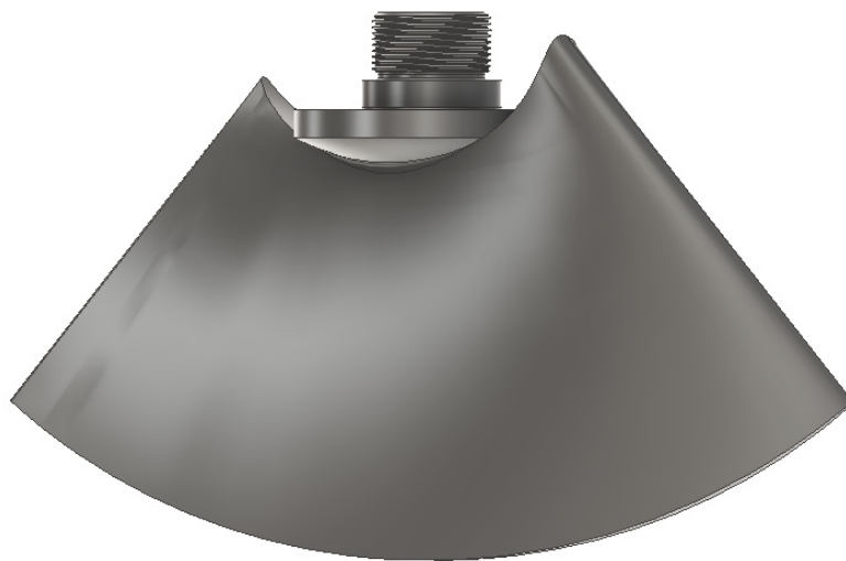
6. ábra: Axiális átömlésű G162 jelű szivattyú állítható járókerék komplett lapát 3D geometriai modell két nézeti képe
