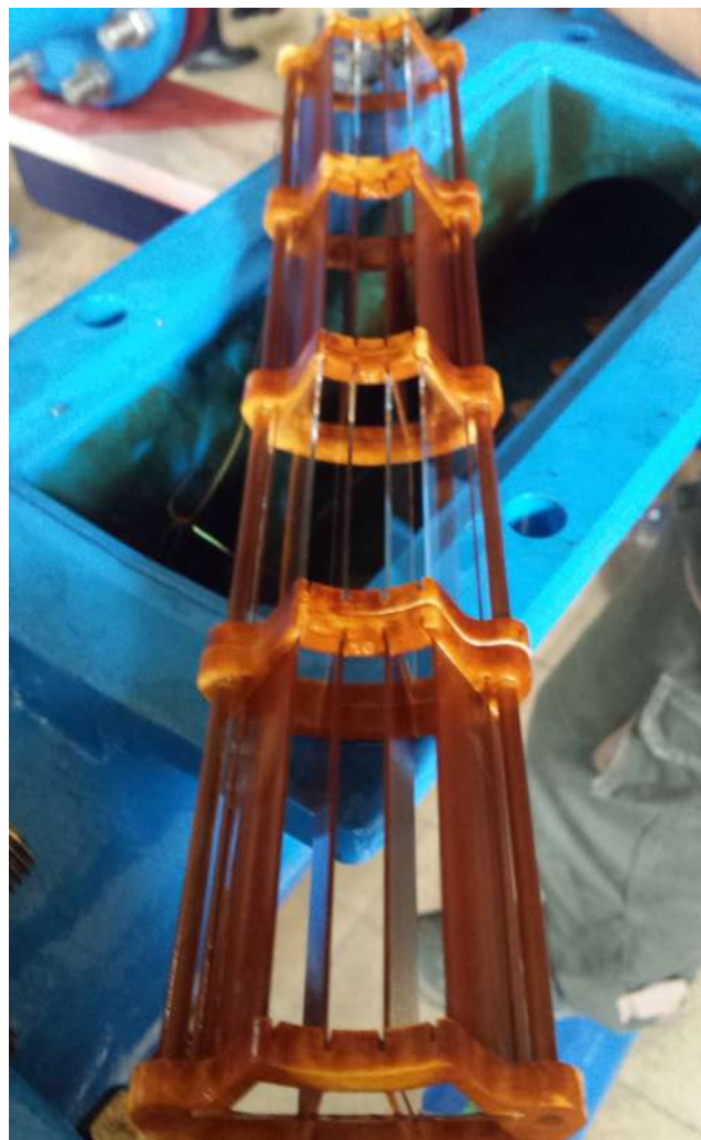
1. ábra – A Hálózati Modell Berendezésbe (HMB) beépített tárgylemeztartó eszköz
