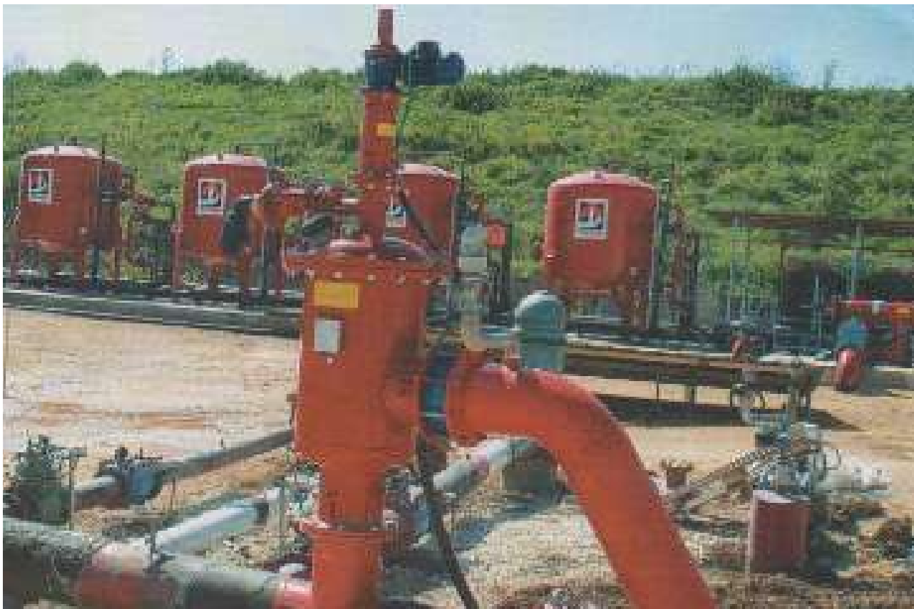
1. ábra Szennyvíztisztít-telepő szűrő berendezése a korlátlan öntözéshez [Golovaty,2008]
