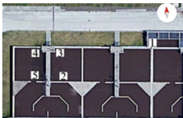
7. ábra – A 2. vonalon található anoxikus medence mintavételi pontok (2021. július 22-től). 1 – osztó akna, 2 belső recirk, 3 - befolyó szennyvíznél, 4 – alsó átfolyásnál, 5 – átfolyó nyílásnál.
