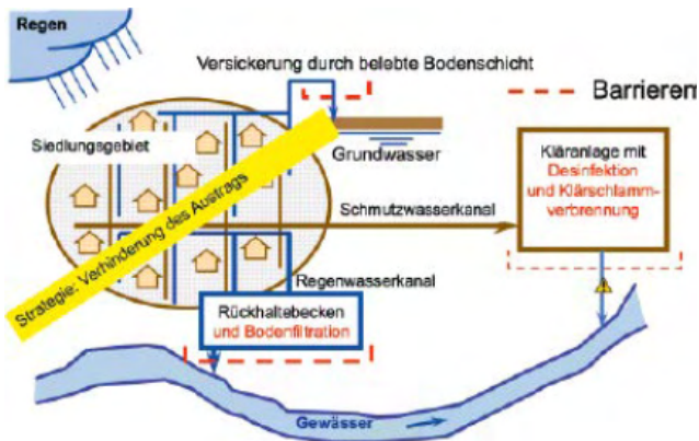
5. ábra: A gáttal kialakított elválasztott rendszerű települési vízelvezető rendszer koncepciója (Gujer [63] ábrája alapján)
