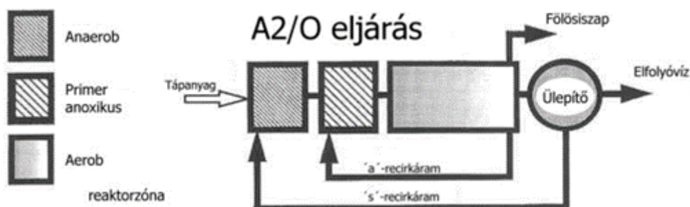
2. ábra. Folyamatos betáplálású eleveniszapos szennyvíztisztító foszfor és nitrogéneltávolító technológia nagykörös iszapcirkulációval és belső körös nitrárecirkulációval.
