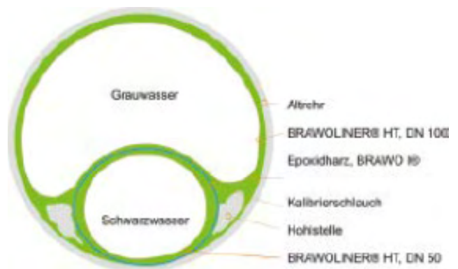
2. ábra: Csőben-cső keresztmetszet, az EVaSENS (fent) és az AWAS (lent) elv szerint (© Ben Schäfer)
