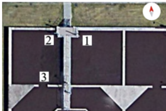
6. ábra – A 2. vonalon található anoxikus medence mintavételi pontok (2021. július 13. napig). 1 – befolyó szennyvíznél, 2 – alsó átfolyásnál, 3 – átfolyó nyílásnál.
