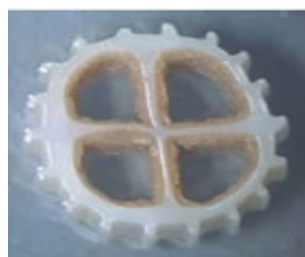
7. ábra. Klasszikus Kaldnes töltet (fenti kép), valamint többretegű biofilm hordozó a legkorszerűbb biochip lemezekkel (bal oldali kép).
