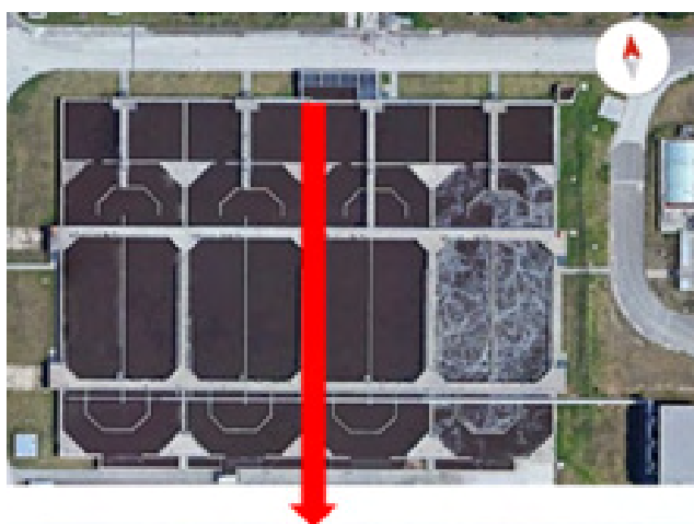
7. ábra – A 2. vonalon található anoxikus medence mintavételi pontok (2021. július 22-től). 1 – osztó akna, 2 belső recirk, 3 - befolyó szennyvíznél, 4 – alsó átfolyásnál, 5 – átfolyó nyílásnál.
